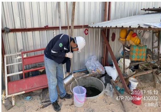
รูปที่ 6 บ่อพักน้ำ/ดักเศษตะกอนดิน
